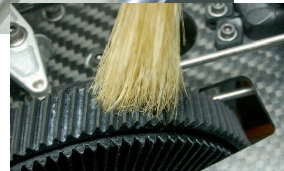
Das Auftragen auf größere Bauelemente wie Hauptzahnrad ist eine Sisyphosarbeit. Ein Pinsel erleichtert das Auftragen, erhöht allerdings auch den Verbrauch. Nach dem Verdunsten der Trägerflüssigkeit verbleibt an den bearbeiteten Stellen eine weiße Schicht des Trockenschmiermittels.
